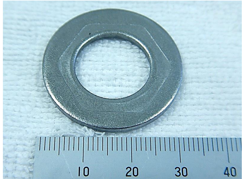
図3. 平座金が陥没した例。
